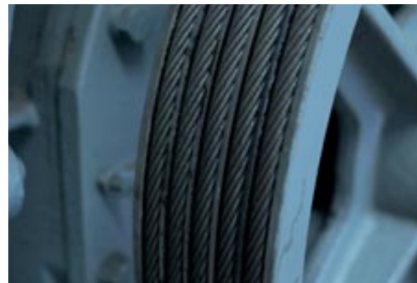
Câbles de traction, ascenseurs, monte-charge, sas, écluses
